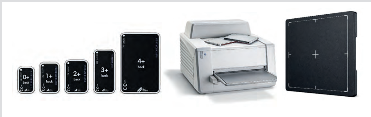
Figura 1. Placas de radiografía analógica (izquierda), escáner CR (centro) y detector DR (derecha). (Fuente: web)
