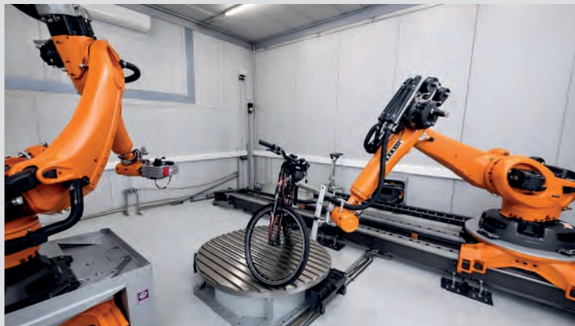
Figura 9. Sistema de radiografía y CT basado en robots realizando una tomografía de una bicicleta. (Fuente: web )
