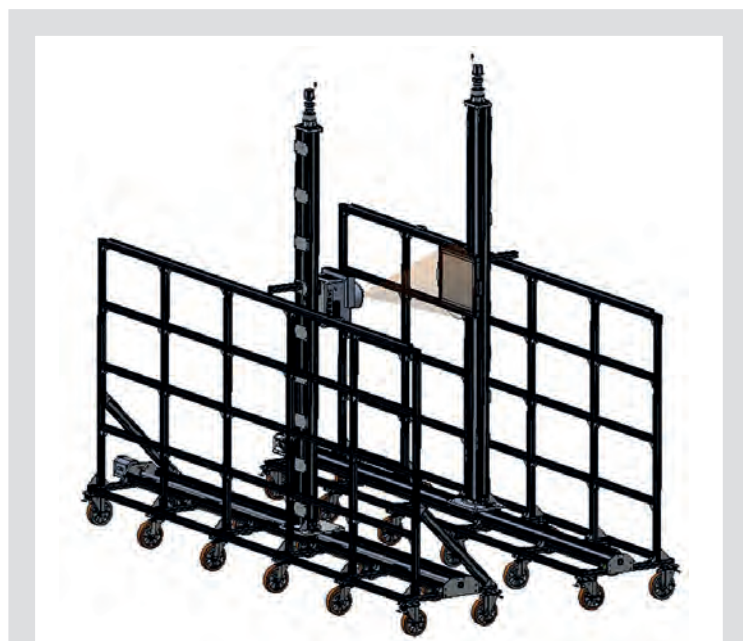
Figura 7. Sistema dual de radiografía automática de gran formato, denominado WideXcan
